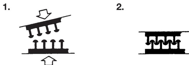
Dual Lock flexibler Druckverschluß ist zudem selbstklebend ausgerüstet, für permanente Verbindungen. Hierdurch werden bekannte Nachteile herkömmlicher Befestigungssysteme vermieden: Kein umständliches Arbeiten mit Schrauben oder Nieten, keine sichtbaren Löcher, die das optische Aussehen einer Oberfläche beeinträchtigen.
